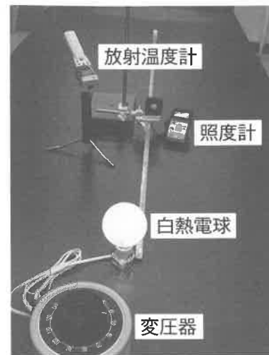
図3 電圧と照度、温度の関係を測定する装置
