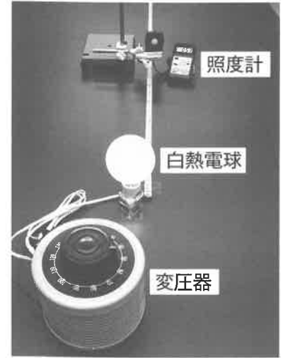
図1 距離と照度の関係を測定する装置
